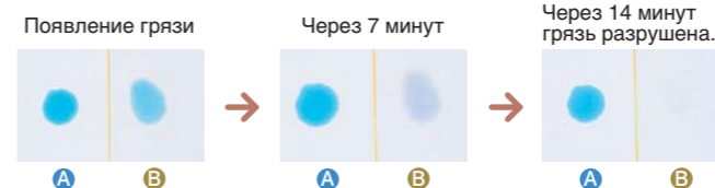
A Обычная панель B Панель с керамическим покрытием с фотокатализаторами
